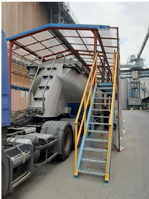
[하역업체 차량점검대 설치 예시]
