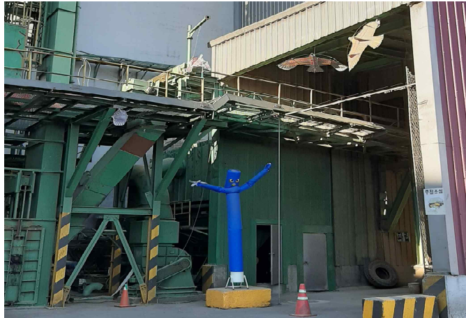
[움직이는 풍선을 이용한 비둘기 통제장치 예시]
