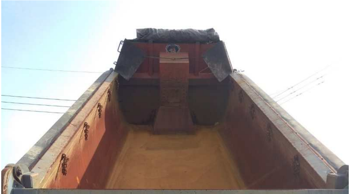
[덤프 적재함 내부의 전경. 잔류물이 묻쳐 적재함 틈새에 부착된 후 쌓이는 경우가 많음]
